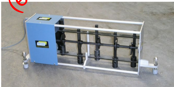
Abb. 18.3 Norm-Hammerwerk, Norsonic Typ 21 (Foto: HBT-Isol, Bremgarten; www.hbt-isol.ch)
