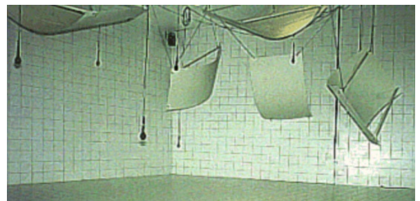
Abb. 15.7 Hallraum zur Bestimmung der \alpha_s -Werte
